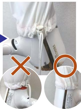
本体最下部の給風口にヘアードライヤーの吹出口を入れ、シリコンリングが完全に見えない位置で、リングに固定ヒモが引っかかるように、ヒモを絞って固定します。
